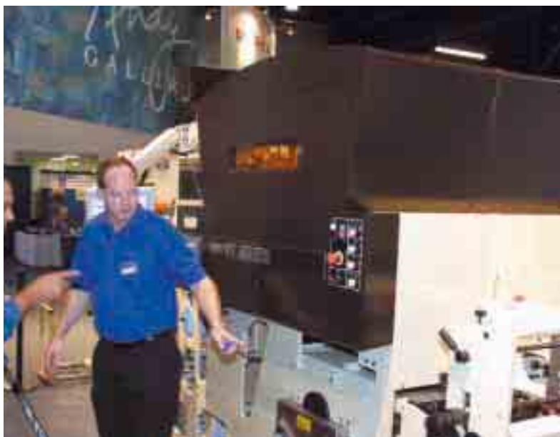
Inkjet imaging module on Mark Andy 2200 press
